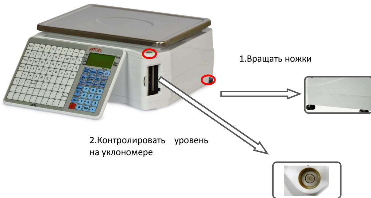
Рисунок 8. Установка оборудования на горизонтальной поверхности
