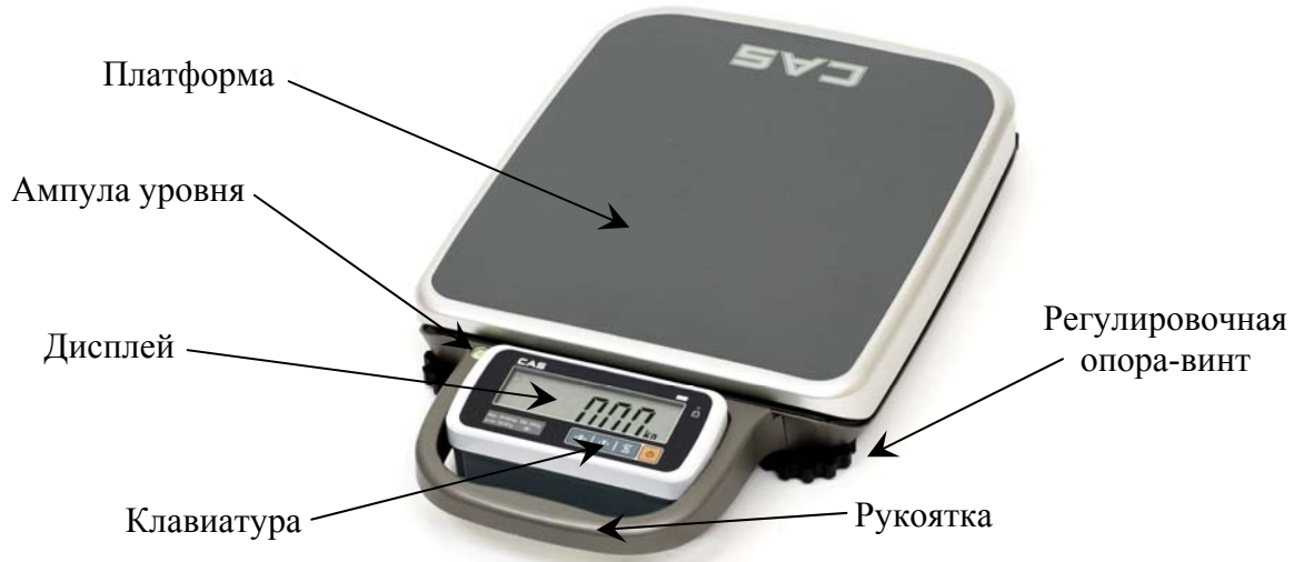
Рисунок 4.1 – Общий вид весов «РВ», основные элементы
