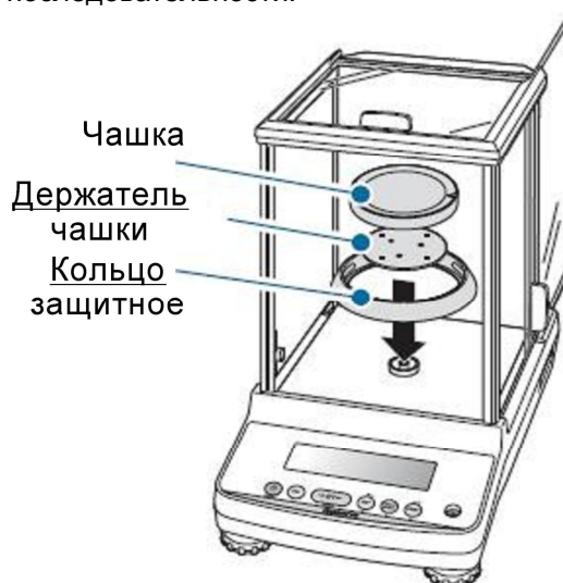
Рисунок 5 – Монтаж весов
