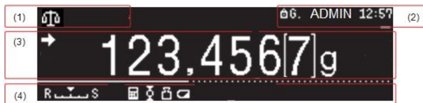
Рисунок 4 – Дисплей весов (изображение для режима стандартного взвешивания)
