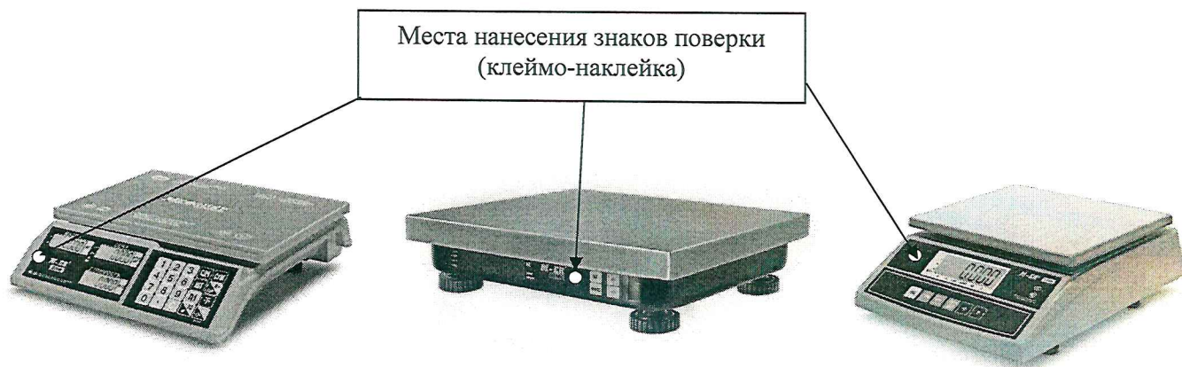
Рисунок 2.1 — Весы с компонентами терминалов, смонтированными в корпусе
